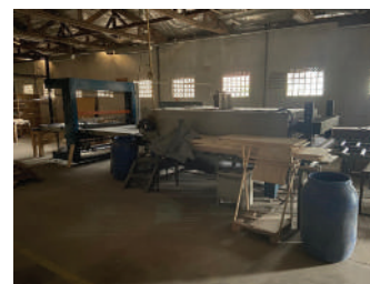
70. 1 Seladora e túnel de encolhimento Shanklin com esteira de entrada
