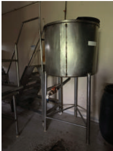
113.1 Tanque de inox para preparação de molho com escada
