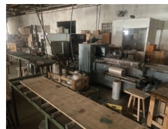
71. 1 Máquina de embalar com túnel a gás Projepac
