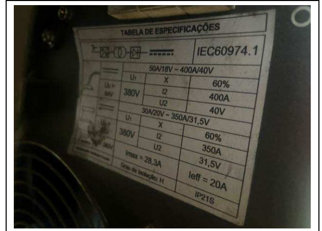
010 – ITEM 201 - MÁQUINA DE SOLDA MIG, WELD VISION / STROM 400 (PLACA ESPECIFICAÇÕES).
