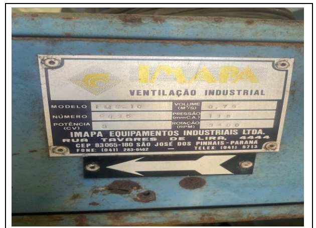
008 – ITEM 200 - COLETOR DE PÓ INDUSTRIAL, IMAPA / FMS-10 (PLACA DE ESPECIFICAÇÕES).
