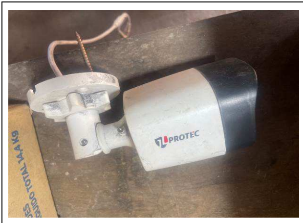
021 – ITEM 210.4 - CAMERA DE MONITORAMENTO BULLET, PROTEC / JL-10KF20B.
