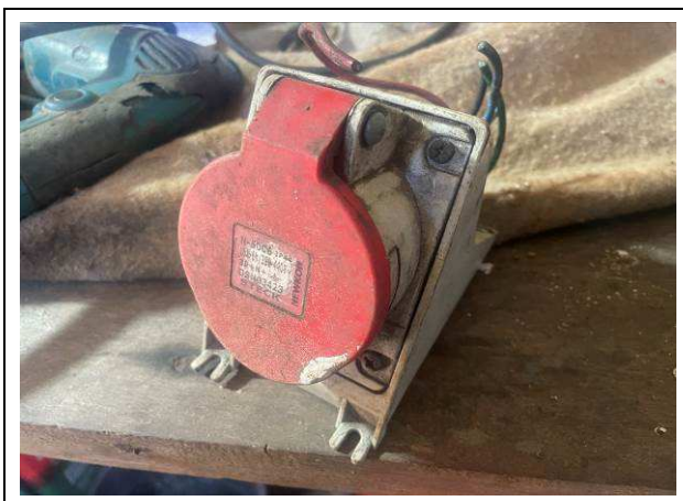
031 – ITEM 209.2 – TOMADA INDUSTRIAL DE EMBUTIR.
